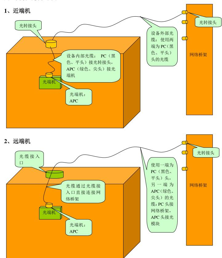
注意:光缆接入到光模块和桥架时必须型号对应,否则损耗很大。
